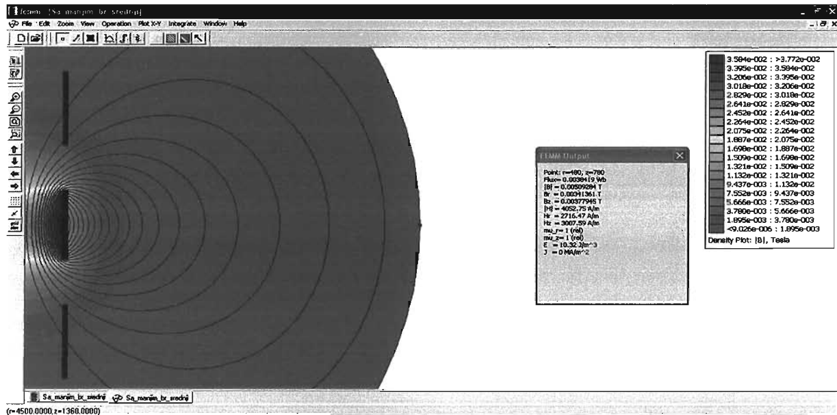
Slika 15. Raspodela magnetske indukcije u prostoru (poluprečnik radnog prostora je 4 metra od ose prigušnice), kada samo kroz srednji namotaj teče struja, uz prisustvo gornjeg i donjeg namotaja
